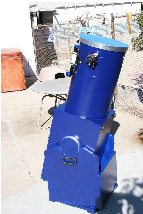
Φωτ.3 : Ένα από τα αρχικά Dobsonian τηλεσκόπια που έφεραν επανάσταση στην ερασιτεχνική αστρονομία
